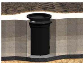
Se ha de tener especial precaución en la compactación del material de relleno alrededor de la arqueta. Deberá compactarse con Vibro-compactadores ligeros o pisones no metálicos. Es muy importante no utilizar maquinaria pesada para la compactación sin tener en cuenta una distancia mínima de separación a la arqueta de entre 1 y 1,5 metros.
